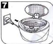
Если работа закончена, выдерните электрическую вилку из розетки и откройте крышку прибора. Вылейте воду из контейнера и протрите его изнутри.
