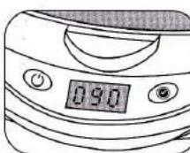
Этот режим используется для усиленной чистки жирных задвижек, зубчатых колес, подшипников и пр. Если выбираете этот режим, используйте функцию подогрева. Эта функция поможет размягчить жир, улучшив результат чистки. При длительной чистке в этом режиме возможны легкие повреждения особо тонких деталей предмета.
